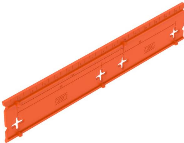
Molde de perfuração para caixas de encastrar e para paredes ocas. Para marcar as distâncias de fixação de 71 ou 91 mm. Com auxiliares de marcação para punção e com entalhes para alinhamento com, por exemplo, corda de marcação.
