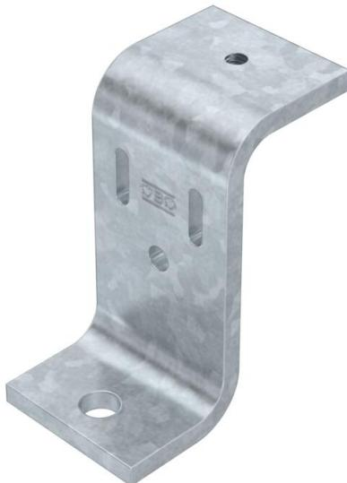
O suporte Z para as elevações no chão do sistema de caminho de cabos em chapa para passageiros BKRS. Fixação do caminho de cabos em chapa ao suporte Z com parafuso de cabeça achatada FKS 6x12 mm (ref. 6049246) no orifício roscado M6.
