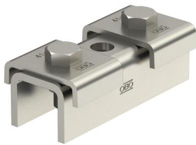
A união de perfis serve de extensão do perfil de montagem MS4141. Esta ligação pode ser efetuada de forma simples e segura no estaleiro ou pré-montada na oficina. É garantida a não existência de pontos frágeis na área do acoplamento dos perfis. Aqui são aplicáveis os valores regulares dos perfis de montagem.
