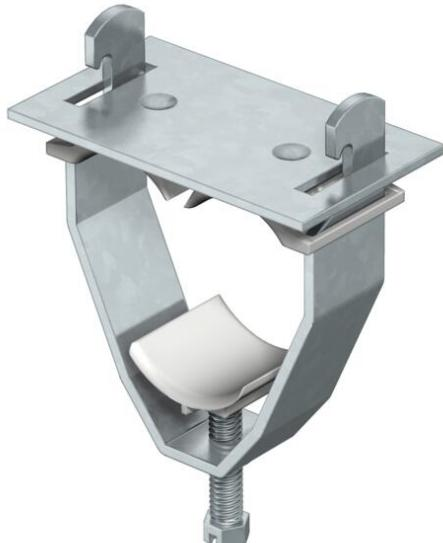
Corpo da abraçadeira, parafuso e contra porca em aço galvanizado a quente após maquinagem, placa e contraplaca em polipropileno, livre de halogéneos, cinzento claro RAL 7035.
