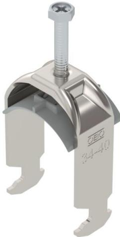
Abraçadeira BBS tipo cabeça de martelo, placa de pressão em plástico de polipropileno. Para montagem vertical e horizontal de 1 cabo individual em perfil C. Para largura de rasgo 16 - 17 mm. Com parafuso simples na placa de pressão, cabeça de parafuso hexagonal universal tam. 10, com fenda e fenda em cruz. Adequado para montagem em áreas interiores e exteriores. Recomenda-se o uso de uma contraplaca.
