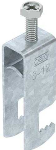
Abraçadeira BBS tipo F, placa de pressão metálica com arestas arredondadas para proteção de cabos. Para montagem vertical e horizontal de 2 cabos individuais em ferros planos. Com parafuso simples na placa de pressão, cabeça de parafuso hexagonal universal tam. 10, com fenda e fenda em cruz. Adequado para montagem em áreas interiores e exteriores. Vários cabos devem ser separados por placas duplas. Recomenda-se o uso de uma contraplaca.
