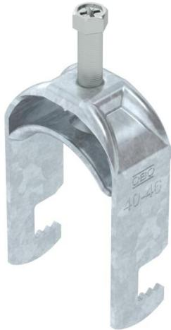
Abraçadeira BBS tipo F, placa de pressão metálica com arestas arredondadas para proteção de cabos. Para montagem vertical e horizontal de 1 cabo individual em ferros planos. Com parafuso simples na placa de pressão, cabeça de parafuso hexagonal universal tam. 10, com fenda e fenda em cruz. Adequado para montagem em áreas interiores e exteriores. Recomenda-se o uso de uma contraplaca.
