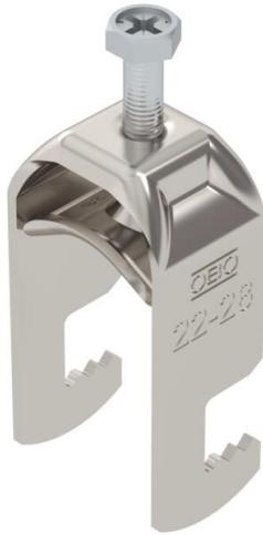
Abraçadeira BBS tipo F, placa de pressão metálica com arestas arredondadas para proteção de cabos. Para montagem vertical e horizontal de 1 cabo individual em ferros planos. Com parafuso simples na placa de pressão, cabeça de parafuso hexagonal universal tam. 10, com fenda e fenda em cruz. Adequado para montagem em áreas interiores e exteriores. Recomenda-se o uso de uma contraplaca.
