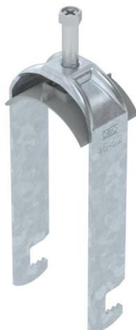
Abraçadeira BBS tipo F, placa de pressão em plástico de polipropileno. Para montagem vertical e horizontal de 2 cabos individuais em ferros planos. Com parafuso simples na placa de pressão, cabeça de parafuso hexagonal universal tam. 10, com fenda e fenda em cruz. Adequado para montagem em áreas interiores e exteriores. Vários cabos devem ser separados por placas duplas. Recomenda-se o uso de uma contraplaca.
