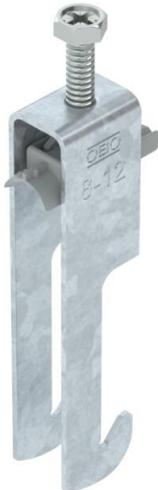
Abraçadeira BBS tipo W, placa de pressão em plástico de polipropileno. Para montagem vertical e horizontal de 2 cabos individuais em ferros angulares até < 40 mm. Com parafuso simples na placa de pressão, cabeça de parafuso hexagonal universal tam. 10, com fenda e fenda em cruz. Adequado para montagem em áreas interiores e exteriores. Vários cabos devem ser separados por placas duplas. Recomenda-se o uso de uma contraplaca.
