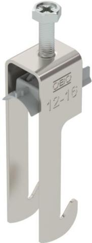
Abraçadeira BBS tipo W, placa de pressão em plástico de polipropileno. Para montagem vertical e horizontal de 1 cabo individual em ferros angulares até < 40 mm. Com parafuso simples na placa de pressão, cabeça de parafuso hexagonal universal tam. 10, com fenda e fenda em cruz. Adequado para montagem em áreas interiores e exteriores. Recomenda-se o uso de uma contraplaca.
