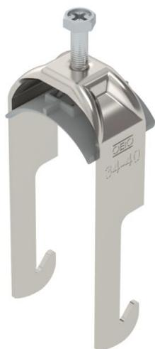
Abraçadeira BBS tipo W, placa de pressão em plástico de polipropileno. Para montagem vertical e horizontal de 1 cabo individual em ferros angulares até < 40 mm. Com parafuso simples na placa de pressão, cabeça de parafuso hexagonal universal tam. 10, com fenda e fenda em cruz. Adequado para montagem em áreas interiores e exteriores. Recomenda-se o uso de uma contraplaca.
