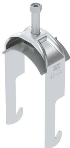
Abraçadeira BBS tipo W, placa de pressão em plástico de polipropileno. Para montagem vertical e horizontal de 1 cabo individual em ferros angulares até < 40 mm. Com parafuso simples na placa de pressão, cabeça de parafuso hexagonal universal tam. 10, com fenda e fenda em cruz. Adequado para montagem em áreas interiores e exteriores. Recomenda-se o uso de uma contraplaca.
