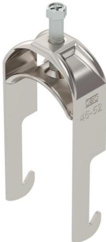
Abraçadeira BBS com tipo W, placa de pressão metálica com arestas arredondadas para proteção de cabos. Para montagem vertical e horizontal de 1 cabo individual em ferros angulares até < 40 mm. Com parafuso simples na placa de pressão, cabeça de parafuso hexagonal universal tam. 10, com fenda e fenda em cruz. Adequado para montagem em áreas interiores e exteriores. Recomenda-se o uso de uma contraplaca.
