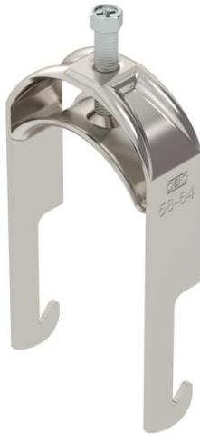
Abraçadeira BBS com tipo W, placa de pressão metálica com arestas arredondadas para proteção de cabos. Para montagem vertical e horizontal de 1 cabo individual em ferros angulares até < 40 mm. Com parafuso simples na placa de pressão, cabeça de parafuso hexagonal universal tam. 10, com fenda e fenda em cruz. Adequado para montagem em áreas interiores e exteriores. Recomenda-se o uso de uma contraplaca.
