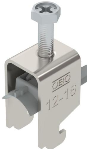
Abraçadeira BBS tipo N, placa de pressão em plástico de polipropileno. Para montagem vertical e horizontal de 1 cabo individual em perfil C. Para largura de rasgo 11 - 12 mm. Com parafuso simples na placa de pressão, cabeça de parafuso hexagonal universal tam. 10, com fenda e fenda em cruz. Adequado para montagem em áreas interiores e exteriores. Recomenda-se o uso de uma contraplaca.
