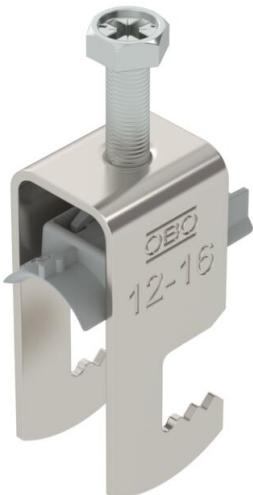
Abraçadeira BBS tipo F, placa de pressão em plástico de polipropileno. Para montagem vertical e horizontal de 1 cabo individual em ferros planos. Com parafuso simples na placa de pressão, cabeça de parafuso hexagonal universal tam. 10, com fenda e fenda em cruz. Adequada para montagem em áreas interiores e exteriores. Recomenda-se o uso de uma contraplaca.
