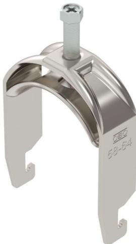
Abraçadeira BBS tipo U, placa de pressão metálica com arestas arredondadas para proteção de cabos. Para montagem vertical e horizontal de 1 cabo individual em perfil C. Para largura de rasgo 18 - 22 mm. Com parafuso simples na placa de pressão, cabeça de parafuso hexagonal universal tam. 10, com fenda e fenda em cruz. Adequada para montagem em áreas interiores e exteriores. Recomenda-se o uso de uma contraplaca.
