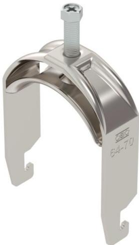
Abraçadeira BBS tipo U, placa de pressão metálica com arestas arredondadas para proteção de cabos. Para montagem vertical e horizontal de 1 cabo individual em perfil C. Para largura de rasgo 18 - 22 mm. Com parafuso simples na placa de pressão, cabeça de parafuso hexagonal universal tam. 10, com fenda e fenda em cruz. Adequada para montagem em áreas interiores e exteriores. Recomenda-se o uso de uma contraplaca.
