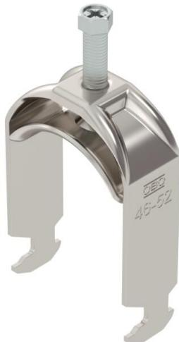
Abraçadeira BBS tipo cabeça de martelo, placa de pressão metálica com arestas arredondadas para proteção de cabos. Para montagem vertical e horizontal de 1 cabo individual em perfil C. Para largura de rasgo 16 - 17 mm. Com parafuso simples na placa de pressão, cabeça de parafuso hexagonal universal tam. 10, com fenda e fenda em cruz. Adequada para montagem em áreas interiores e exteriores. Recomenda-se o uso de uma contraplaca.
