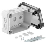
Caixa de derivação com calha DIN para conectar cabos e tubos em áreas interiores e exteriores. Forma retangular com entradas quebráveis. Adequado para montagem na parede e teto com opção para fixação externa ou montagem através de parafusos nos cantos. Particularmente resistente ao impacto com IK09. Tampa transparente com fecho rápido, pode ser selada a chumbo. Fabricada em materiais resistentes aos raios UV e livres de halogéneo.
