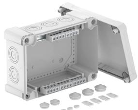
Caixa de derivação com régua de bornes para conectar cabos e tubos em áreas interiores e exteriores. Forma retangular com entradas quebráveis. Adequado para montagem na parede e teto com opção para fixação externa ou montagem através de parafusos nos cantos. Particularmente resistente ao impacto com IK09. Tampa com fecho rápido, pode ser selada a chumbo. Fabricada em materiais resistentes aos raios UV e livres de halogéneo.
