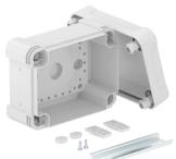
Caixa de derivação com calha DIN para conectar cabos e tubos em áreas internas e exteriores. Forma retangular sem entradas. Adequado para montagem na parede e teto com opção para fixação externa ou montagem através de parafusos nos cantos. Particularmente resistente ao impacto com IK09. Tampa com fecho rápido, pode ser selada a chumbo. Fabricada em materiais resistentes aos raios UV e livres de halogéneo.
