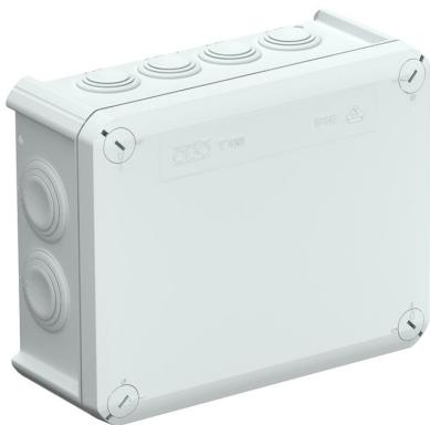
Caixa de derivação para conectar cabos em áreas interiores e áreas exteriores protegidas. Forma retangular com bucinos cónicos nas laterais e entradas quebráveis na base. Adequado para a montagem na parede / teto e para a montagem em suportes para caixas de derivação. Com opção de fixação interna e montagem através de parafusos nos cantos. Tampa com fecho rápido, pode ser selada a chumbo. Fabricada em materiais resistentes aos raios UV e livres de halogéneo.
