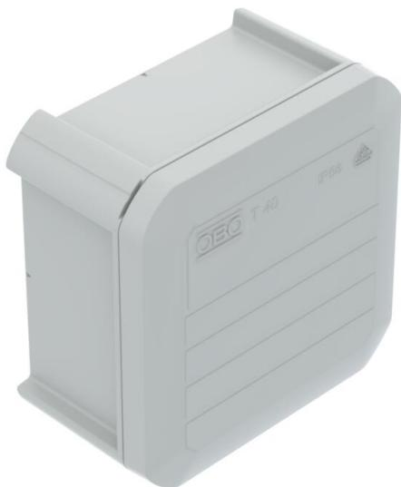
Caixa de derivação para conectar cabos em áreas interiores e áreas exteriores protegidas. Forma quadrada sem entradas. Adequado para a montagem na parede / teto e para a montagem em suportes para caixas de derivação. Com opção de fixação interna e montagem através de parafusos nos cantos. Com tampa de aperto fixa. Fabricada em materiais resistentes aos raios UV e livres de halogéneo.
