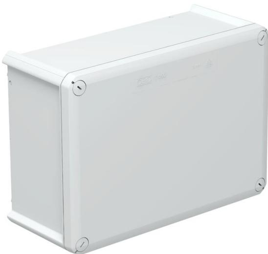
Caixa de derivação fechada para conectar cabos e condutas na área interior e áreas exteriores protegidas. Forma retangular sem entradas. Adequado para a montagem na parede e teto, a montagem em suportes para caixas de derivação e na base da caixa. Com opção de fixação interna e montagem através de parafusos nos cantos. Tampa com fecho rápido, pode ser selada a chumbo. Fabricada em materiais resistentes aos raios UV e livres de halogéneo.
