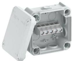
Caixa de derivação com régua de bornes para conectar cabos em áreas interiores e áreas exteriores protegidas. Forma quadrada com bucinos cónicos nas laterais e entradas quebráveis na base. Adequado para a montagem na parede / teto e para a montagem em suportes para caixas de derivação. Com opção de fixação interna e montagem através de parafusos nos cantos. Tampa com fecho rápido, pode ser selada a chumbo. Fabricada em materiais resistentes aos raios UV e livres de halogéneo.
