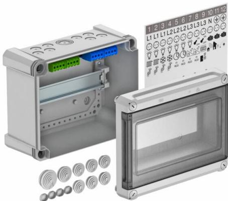
Quadro de distribuição com régua de bornes para montagem à superfície, para sub-distribuição de energia em área interior e área exterior protegida, de acordo com a IEC 439-3. Com calha DIN de 35 mm pré-montada. Classe de proteção IP66 e grau de proteção IK07. Tampa transparente para aparafusar, com recorte.
