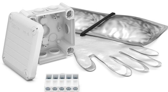
Conjunto composto por caixa de derivação T 60 com régua de bornes, resina fundida e um par de luvas descartáveis. Resina fundida de 2 componentes num saco de mistura para proteger a instalação elétrica contra humidade de acordo com a classe de proteção IP 68 e cargas mecânicas. A resina fundida tem uma baixa temperatura de endurecimento e uma temperatura de processamento de 0-35 °C. A quantidade de resina fundida contida corresponde ao volume da caixa.
