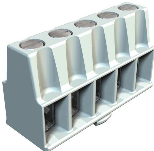
Régua de bornes e parafusos em aço galvanizados e passivados, secção transversal nominal 1,5 ÷ 6 mm<sup>2</sup>, tensão nominal 400 V, 5 pólos, secção transversal máx. que pode ser ligada por cada ponto de aperto: 3x6mm<sup>2</sup>, 4x4mm<sup>2</sup> ou 6x2,5mm<sup>2</sup>.
