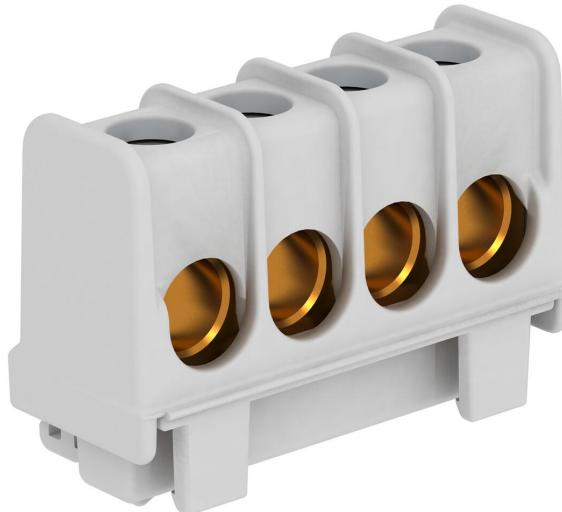
Bornes em latão, parafusos em aço, galvanizados e passivados de forma transparente, secção transversal nominal de 16 ÷ 35 mm<sup>2</sup>, tensão nominal de 400 V, de 1 polo, com conjunto de bornes max. 4x35mm<sup>2</sup>, 4x25mm<sup>2</sup>, 8x16mm<sup>2</sup> ou 12x10mm<sup>2</sup>.
