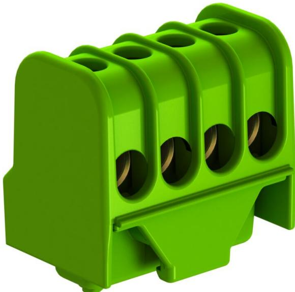
Borne de ligação com condutor de proteção, bornes em latão, parafusos em aço, galvanizado a zinco e passivado de forma transparente, secção transversal nominal 6 ÷ 16 mm<sup>2</sup>, tensão nominal 400 V, 1 polo, com bloco de conectores condutores conectáveis máx. por ponto de aperto máx. 4 x 16 mm<sup>2</sup>, 4 x 10 mm<sup>2</sup>, 8 x 6 mm<sup>2</sup> ou 12 x 4 mm<sup>2</sup>.
