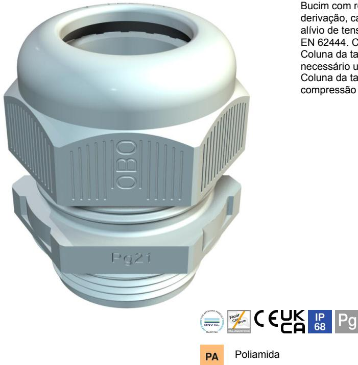
Bucim com rosca de ligação PG em design de porca de capa, para caixas de derivação, caixas, caixas de distribuição no sector privado e industrial. Com alívio de tensão e rebordo de vedação integrado testados de acordo com a DIN EN 62444. Classe de proteção IP68. Aplicável de -20 °C a +65 °C.
