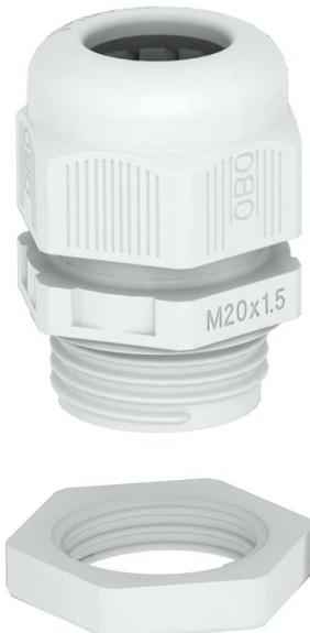
Bucim com rosca de ligação métrica em design de porca de capa, para caixas de derivação, caixas, armários de distribuição no sector privado e industrial. Com alívio de tensão e rebordo de vedação integrado testados de acordo com a DIN EN 62444. Classe de proteção IP68. Aplicável de -20 °C a +65 °C. Inclui contraporca.
