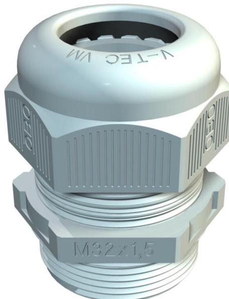
Bucim com rosca de ligação métrica em design de porca de capa, para caixas de derivação, caixas, caixas de distribuição no sector privado e industrial. Com alívio de tensão e rebordo de vedação integrado testados de acordo com a DIN EN 62444. Classe de proteção IP68. Aplicável de -20 °C a +65 °C.
