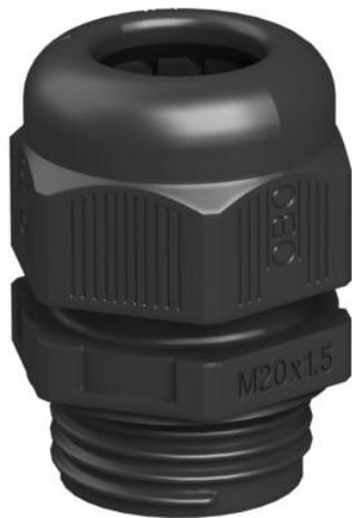
Bucim com rosca de ligação métrica em design de porca de capa, para caixas de derivação, caixas, caixas de distribuição no sector privado e industrial. Com alívio de tensão e rebordo de vedação integrado testados de acordo com a DIN EN 62444. Classe de proteção IP68. Aplicável de -20 °C a +65 °C.
