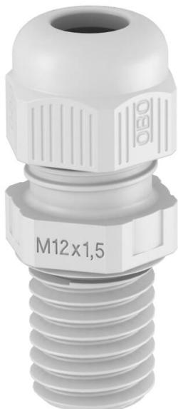
Bucim com rosca de ligação métrica em design de porca de capa, para caixas de derivação, caixas, armários de distribuição no sector privado e industrial. Com alívio de tensão e rebordo de vedação integrado testados de acordo com a DIN EN 62444. Classe de proteção IP68. Aplicável de -20 °C a +65 °C.
