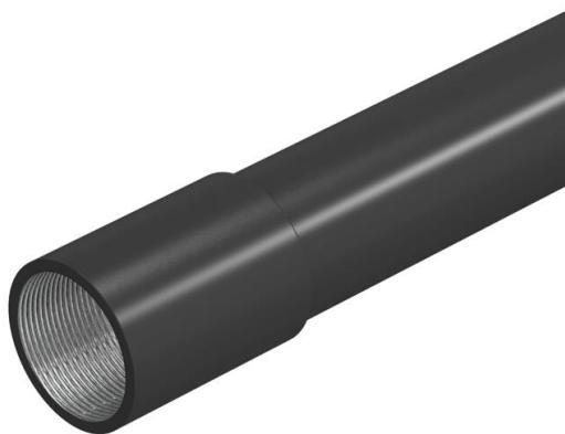
Tubo de instalação elétrica conforme EN 61386-1, com pontas roscadas conforme DIN EN 60423, para a proteção mecânica de cabos e condutores. Com parede interior sem rebarbas. Classe de proteção contra corrosão 2 (média). Cada tubo já inclui uma união instalada.
