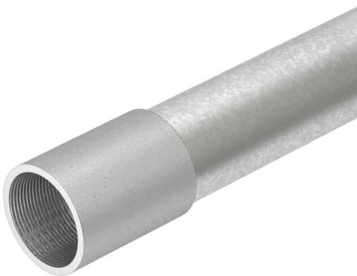
Tubo de instalação elétrica conforme EN 61386-1, com pontas roscadas conforme DIN EN 60423, para a proteção mecânica de cabos e condutores. Com parede interior sem rebarbas. Classe de proteção contra corrosão 4 (elevada). Cada tubo já inclui uma união instalada.
