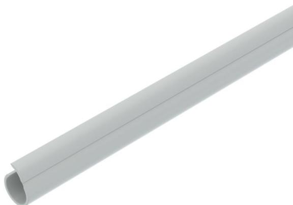
Tubo aberto Quick-Pipe® de plástico para instalação à superfície de cabos e tubos em áreas interiores e áreas exteriores protegidas. Montagem em parede e teto com abraçadeira OBO-Quick, abraçadeira proQuick e abraçadeira Multi-Quick. Fecho e abertura sem ferramentas, girando na abraçadeira. Utilizável com uma amplitude de temperaturas de - 25° a + 60 °C.
