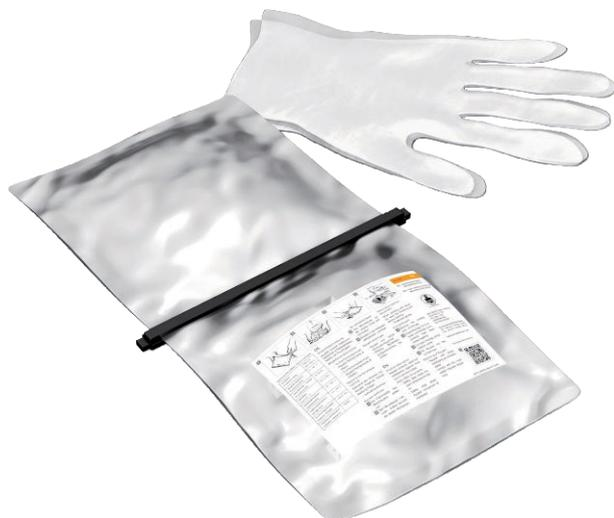
Massa de selagem a frio de dois componentes Aquasit em saqueta de alumínio, para enchimento de caixas de derivação no exterior com uma humidade extremamente elevada e constante. Também pode ser usada para choque mecânico. Tempo de processamento de 20 minutos após abertura e mistura. Pode ser armazenada selada a 0 até 40 °C durante até 24 meses após a data de produção. As experiências, testes e confirmações são válidos apenas em conjunto com as caixas de derivação OBO.
