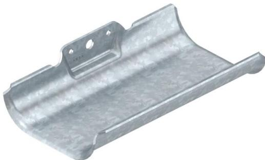
Porta-cabos para uma colocação de cabos simples e rápida em áreas de aplicação em que não possam ser montados sistemas de caminhos de cabos convencionais. Os porta-cabos possuem uma grande superfície de contacto e arestas exteriores arredondadas para a proteção dos cabos. Com base na norma VIN DVE 0298-300, não deve ser excedida a distância de apoio de 0,8 m.
