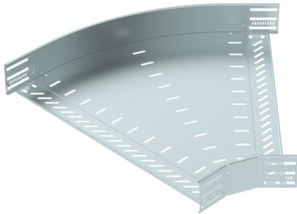
Ângulo de 45° para a criação de um ramal horizontal, para caminhos de cabos em chapa de encaixe e de aparafusar, altura lateral de 85 mm. Montagem sem parafusos com grampos duplos ou ligação rosada com parafusos de cabeça boleada FRS e porcas combinadas M6. Aplicável em áreas interiores. O material de fixação terá que ser encomendado em separado.
