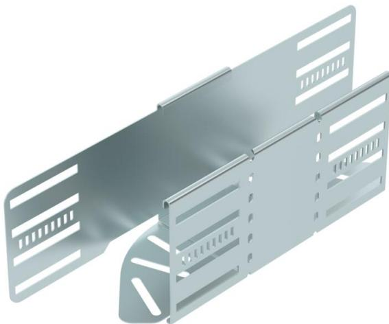
Ângulo ajustável para a criação de um ramal horizontal, para caminhos de cabos em chapa de encaixe e de aparafusar, altura lateral de 110 mm. Ângulo ajustável de 0 - 90°. Montagem sem parafusos com grampos duplos ou ligação rosada com parafusos de cabeça boleada FRS e porcas combinadas M6. Aplicável em áreas interiores. O material de fixação terá que ser encomendado em separado.
