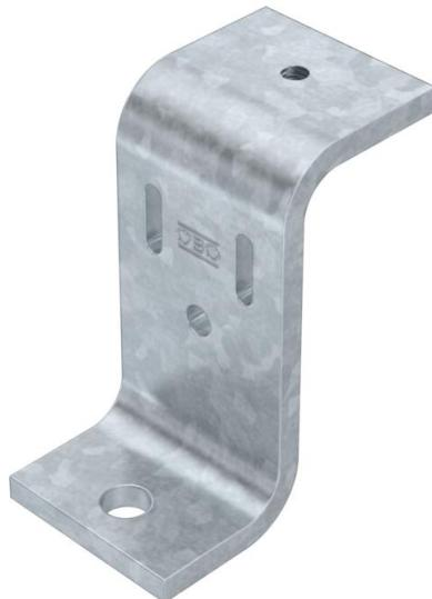
O suporte Z para as elevações no chão do sistema de caminho de cabos em chapa para passagens BKRS. Fixação do caminho de cabos em chapa ao suporte Z com parafuso de cabeça achatada FKS 6x12 mm (ref. 6049246) no orifício roscado M6.
