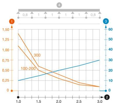
Diagrama de cargas do caminho de cabos do tipo RKSM 35
