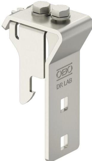
Espaçador para montagem distanciada de caminhos de cabos em chapa, em tetos e paredes. Distância em altura 35 mm, aço inoxidável 1.4301.
