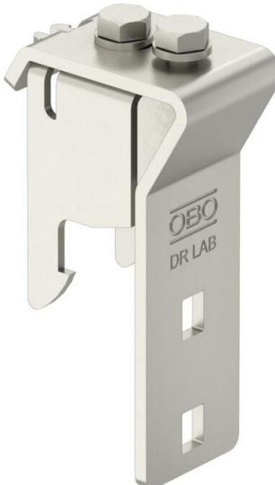
Distanciador para a montagem afastada de tampas em caminhos de cabos para grandes vãos em chapa e tipo escada. Distância em altura 35 mm, aço inoxidável 1.4301.
