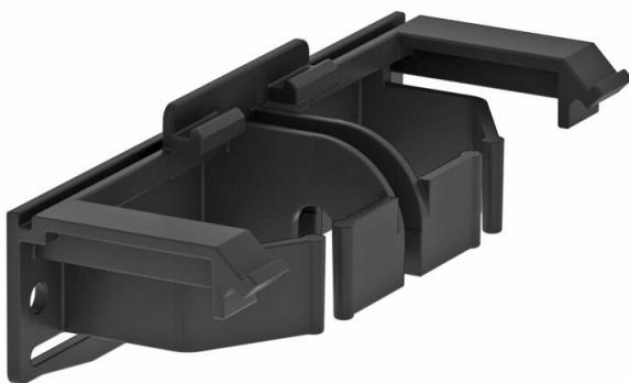
Adaptador de tampa para montagem nas bases da calha e acessórios das séries da calha técnica de design GAD e Rapid IBIS. O adaptador de tampa pode ser inserido na base por uma guia e serve para o encosto de uma tampa mantendo-a à distância desejada. Serve ainda para suporte de cabo existente e pode ser deslocado no sentido longitudinal. Deve ser mantida uma distância máxima de 50 cm entre os adaptadores de tampa.
