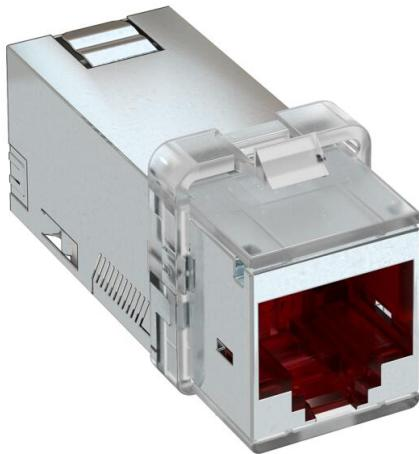
Conecotor cat. 6A (ISO) blindado, com uma slot RJ 45. Inclui uma cobertura blindada CEM, uma capa de proteção antipô, uma moldura de fixação Keystone, uma abraçadeira de fivela e instruções de montagem. Instalação em espelho para conectores de dados do tipo DTG-2C e DTS-2C, platine do tipo MTM 2C e MTM 3C, espelho do tipo MPR2 2C, espelho do tipo MTGE2 2C, MTGE2 15 2C e MTGE2 F 2C.
